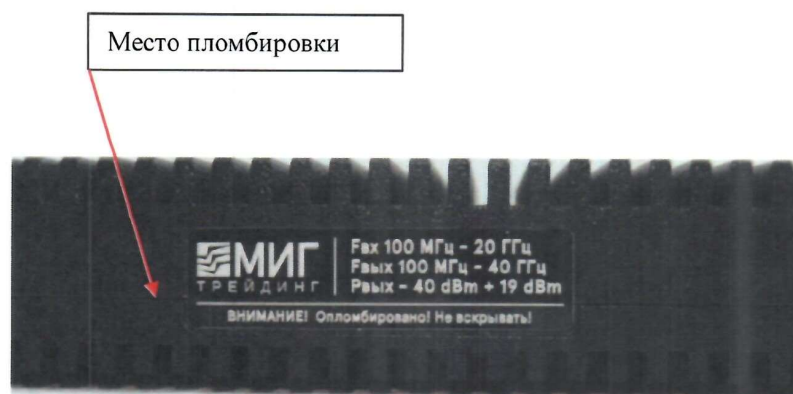
Рисунок 3 – Место пломбирования модуля расширения частоты
